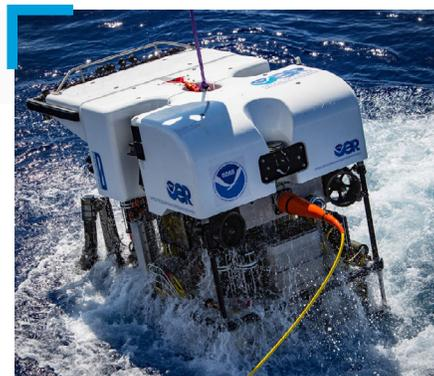
Lanzamiento del ROV Deep Discoverer desde la cubierta trasera del buque *Okeanos Explorer* de la NOAA. Imagen por cortesía de NOAA Ocean Exploration.
